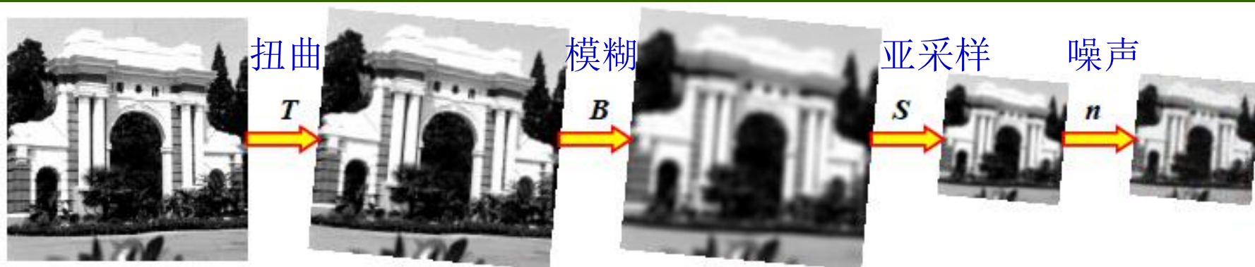
图 15.5.1 高分辨率图像向低分辨率图像的退化过程
